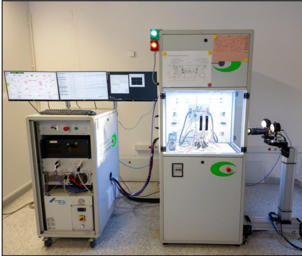
Banc de test PEMWE vue de face
